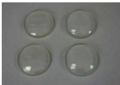
Рисунок 11 – Комплект линз коллиматора лабораторного стенда звездного датчика
