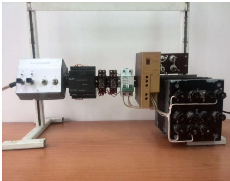
Рисунок 3 – Макет управления электроприводом типа СП-6
