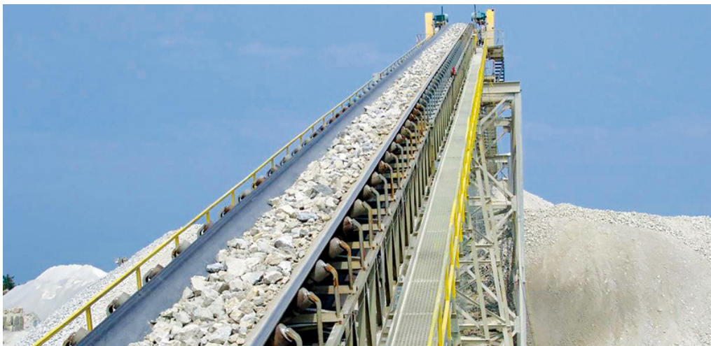
Рис. 2 - Крутонаклонный конвейер Оленегорского карьера Fig. 2 - Steeply inclined conveyor of the Olenegorsky career
