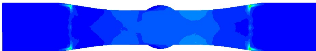
Рисунок 13 – Распределение эквивалентных напряжений по надрессорной балке (жесткий скользян, вид снизу)
