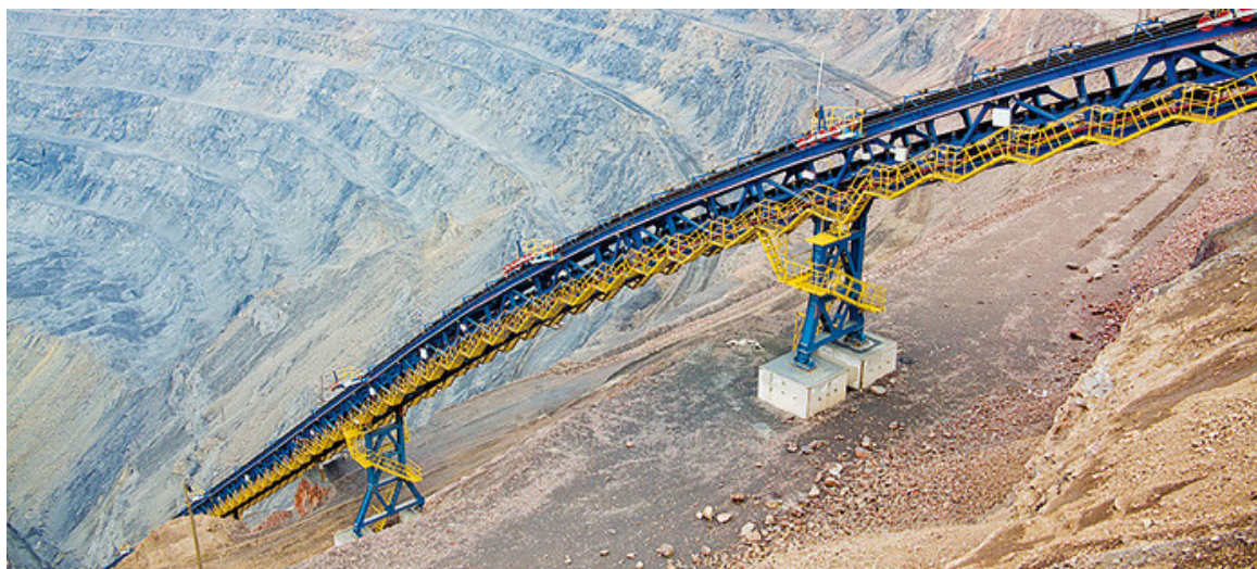
Рис.3 - Крутонаклонный конвейер по доставке руды из глубоких карьеров Fig.3 - High-angle conveyor for the delivery of ore from deep quarries
