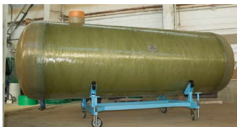
Рисунок 3 – Котел цистерны из стеклопластика полученный методом намотки Fig. 3 – The boiler tank of fiberglass obtained by the winding method
