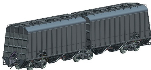
Рисунок 5 – Хopper сочлененного типа модели 19-6978 Fig. 5 – Articulated hopper wagon model 19-6978
