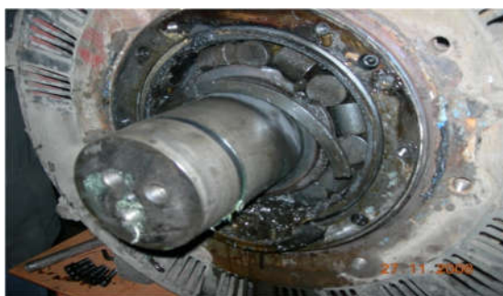
Рис. 2 - Заклинивание подшипников ТЭД Fig. 2 – Jammed bearings ETM
