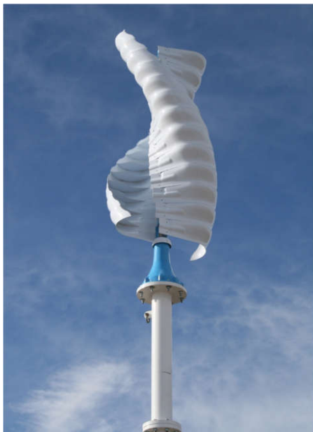
Рис. 2 – Ветровая установка со спиралевидным ротором Fig. 2 – Spiral rotor wind turbine
