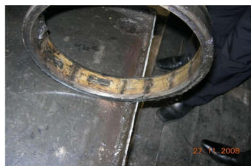
Рис. 2 - Заклинивание подшипников ТЭД Fig. 2 – Jammed bearings ETM
