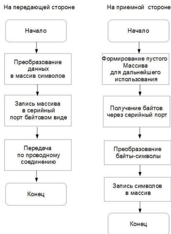
Рисунок 7 – Структурная схема алгоритма коммуникации контроллера Arduino и трансивера LoRa Figure 7 – Структурная схема алгоритма коммуникации контроллера Arduino и трансивера LoRa
