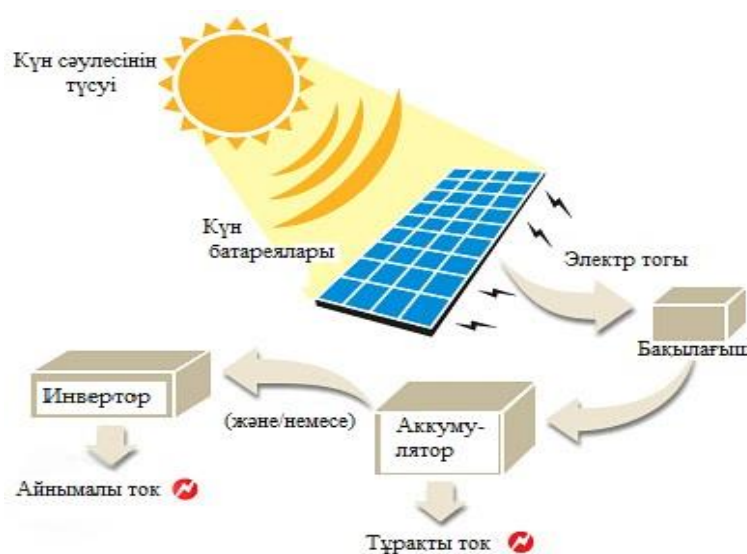
Сурет 1 - Күн батареяларының жұмыс істеу схемасы
