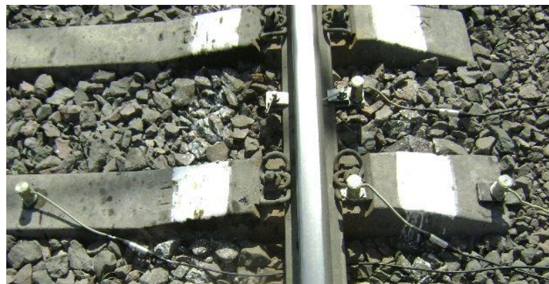
Сурет 2. Орнатылған датчиктері бар теміржол фрагменті
